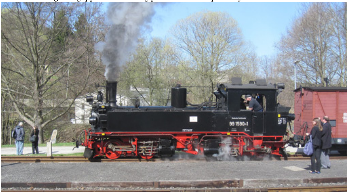
Fotokörning i Steinbach 750 mm Mayer lok, ett boggilok med compoundmaskineri.
