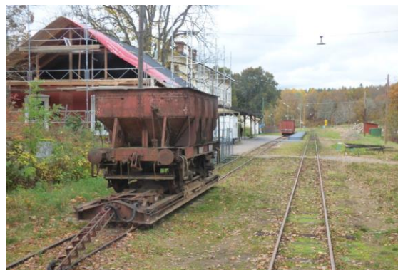
En ovanlig syn på smalspår i dag. En lastad överföringsvagn med normalspårigrusvagn i Ankarsrum. Foto: Håkan Nordenadler
